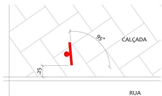
DETALHE DA INSTALAÇÃO DAS PLACAS
